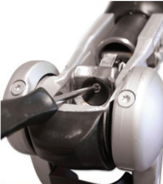
Fig 19 Rimuovere la vite a testa cilindrica
