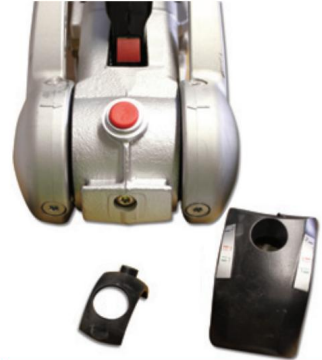
Fig 18 Rivelata la vite a testa cilindrica
