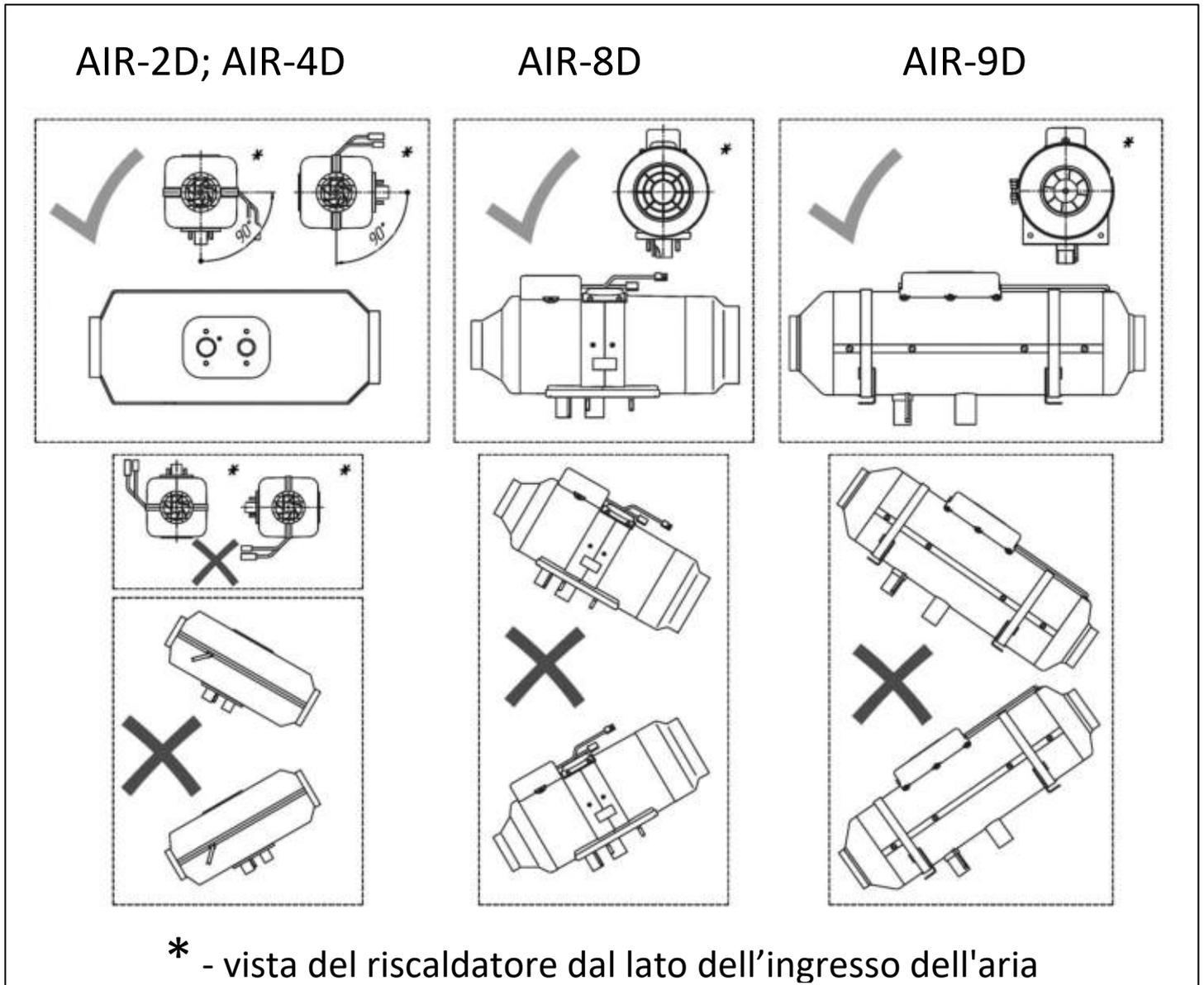
Fig. 1a - Posizioni di montaggio del riscaldatore
