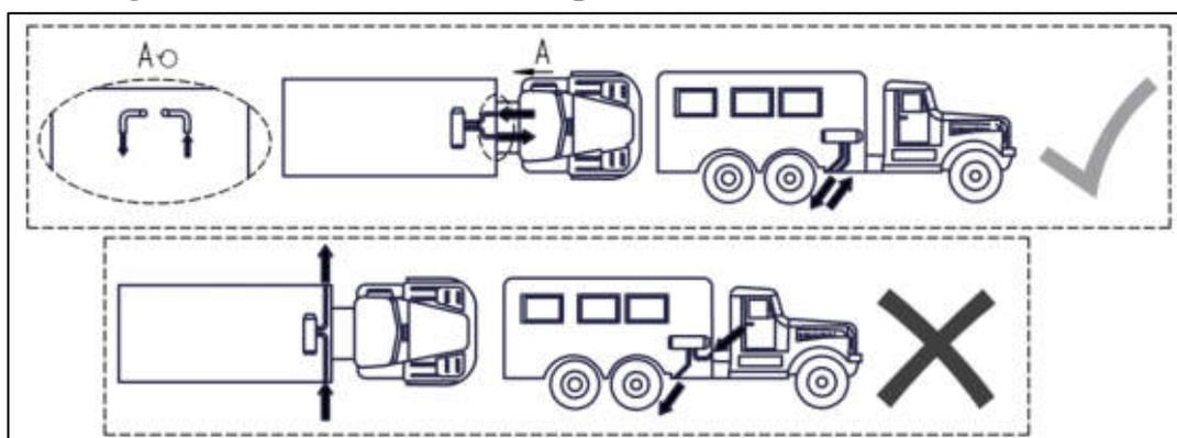
Fig. 6a - Posizione dei tubi di aspirazione e di scarico nei veicoli terrestri
