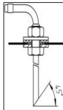
Fig. 15a - Installazione del tubo di aspirazione carburante
