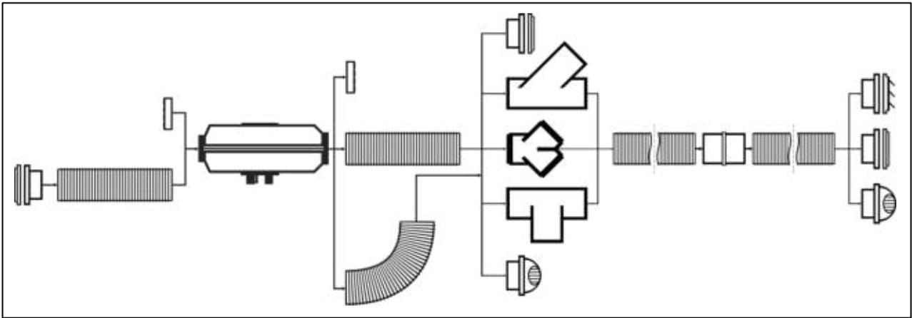
Fig. 26a - Attacchi condotti aria per AIR-2D (60mm)
