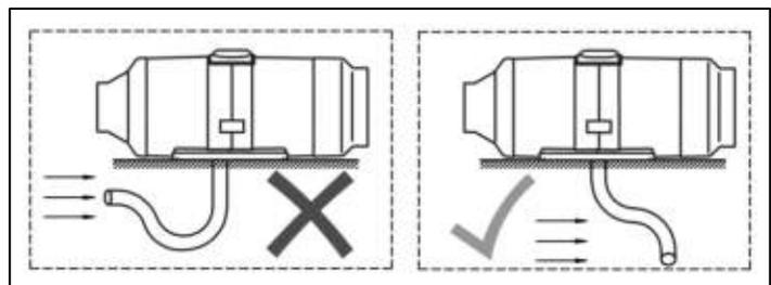
Fig. 5 – Posizione del tubo di aspirazione/scarico dell'aria
