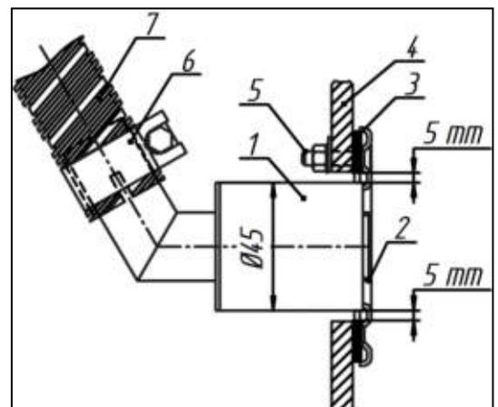
Fig. 13 - Installazione del tubo di scarico
