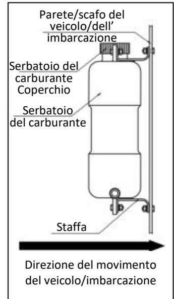
**Fig. 16** Installazione del serbatoio del carburante
