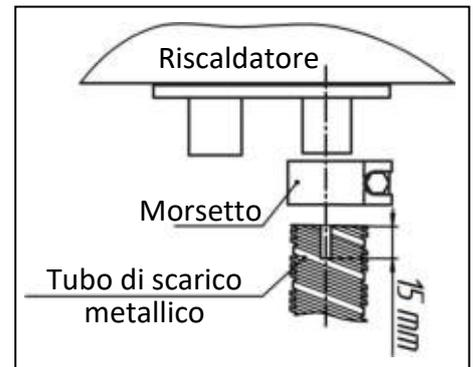
**Fig. 8 - Collegamento del tubo metallico al riscaldatore**
