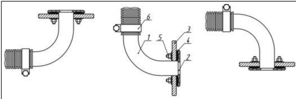
**Fig. 7 - Installazione del tubo di aspirazione dell'aria**
