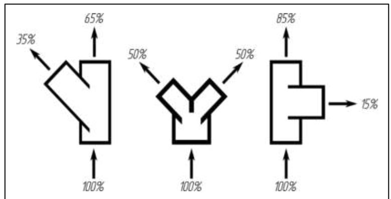
Fig. 25 - Esempi di distribuzione dell'aria con componenti diverse
