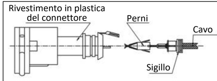
Fig. 22 - Installazione del connettore del cablaggio elettrico della pompa carburante
