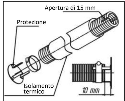
Fig. 9 - Protezione del tubo di scarico
