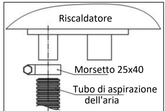
Fig. 4 – Collegamento del tubo dell'aria al riscaldatore
