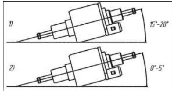
**Fig. 18 - Angolo di installazione della pompa carburante Advers (1) e della pompa carburante Thomas Magnete (2).**
