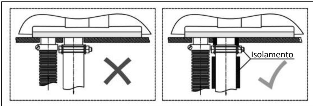
Fig. 12 - Installazione di isolamento supplementare dal calore
