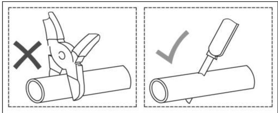
Fig. 21 - Taglio del tubo prima dell'installazione.
