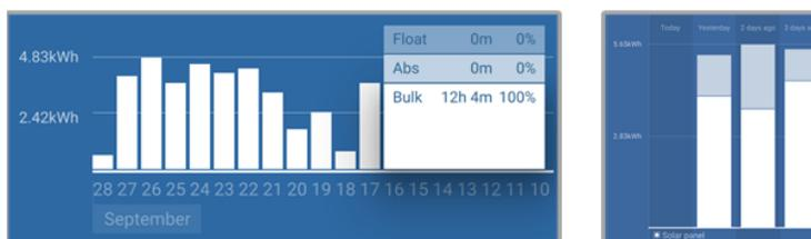
*A sinistra: esempio di un sistema che passa tutto il tempo nella fase di massa. A destra: Ripartizione delle fasi di carica - Il sistema trascorre del tempo nella fase di massa e nella fase di assorbimento.*
