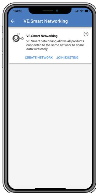
La rete VE.Smart consente a diversi prodotti collegati alla stessa rete di condividere i dati tramite Bluetooth ed è progettata appositamente per i sistemi più piccoli che non hanno installato un dispositivo GX.
