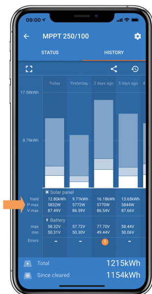
Cronologia di lettura della Pmax dell'app VictronConnect.
