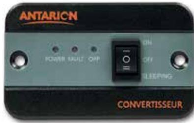
Collegare il telecomando per l'avvio del convertitore con il cavo specifico che deve essere collegato direttamente al convertitore. Si raccomanda di spegnere il convertitore con questo telecomando quando non si utilizza il convertitore. Infatti, questo dispositivo consuma energia quando non è in uso. Guadagnerete così in autonomia.
