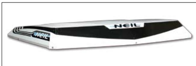
Condizionatore evaporativo con l'innovativo brevetto di PRE-RAFFREDDAMENTO, che consente di mantenere fresco l'abitacolo anche quando l'acqua nel serbatoio è calda.
